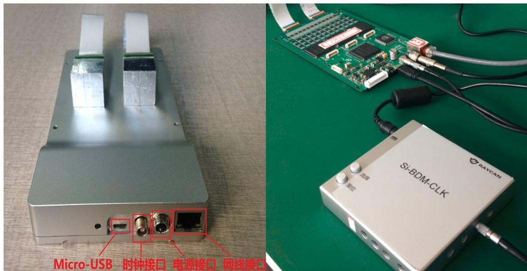
图 3. BDM 的接口说明以及数据采集前的硬件连接
